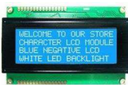
Figura 18: LCD 20x4 mostra diversos dados da produção
