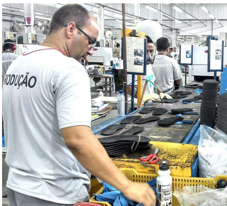
Figura 6: Colaborador colocando palmilha, cabedal e solado na esteira.
