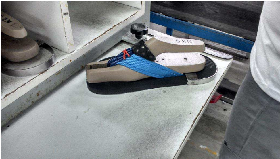
Figura 9: Montagem final do cabedal na palmilha
