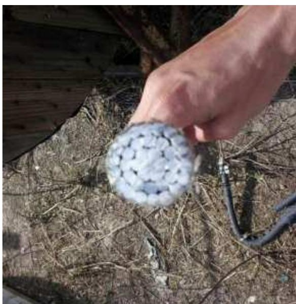
Figura 4.7 – Seção transversal do cabo condutor Orchid.
