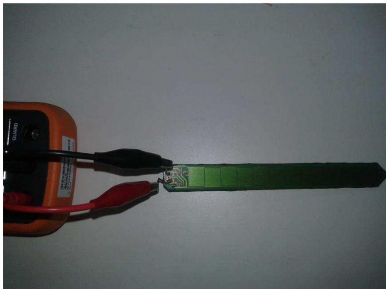
Figura 24: Montagem experimental para a medição da capacitância do sensor imerso em ar.
