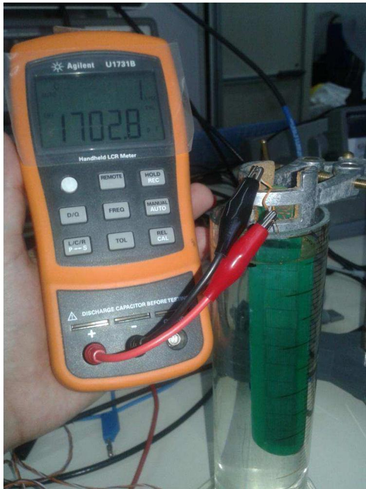
Figura 25: Montagem experimental para a medição da capacitância do sensor imerso em água.
