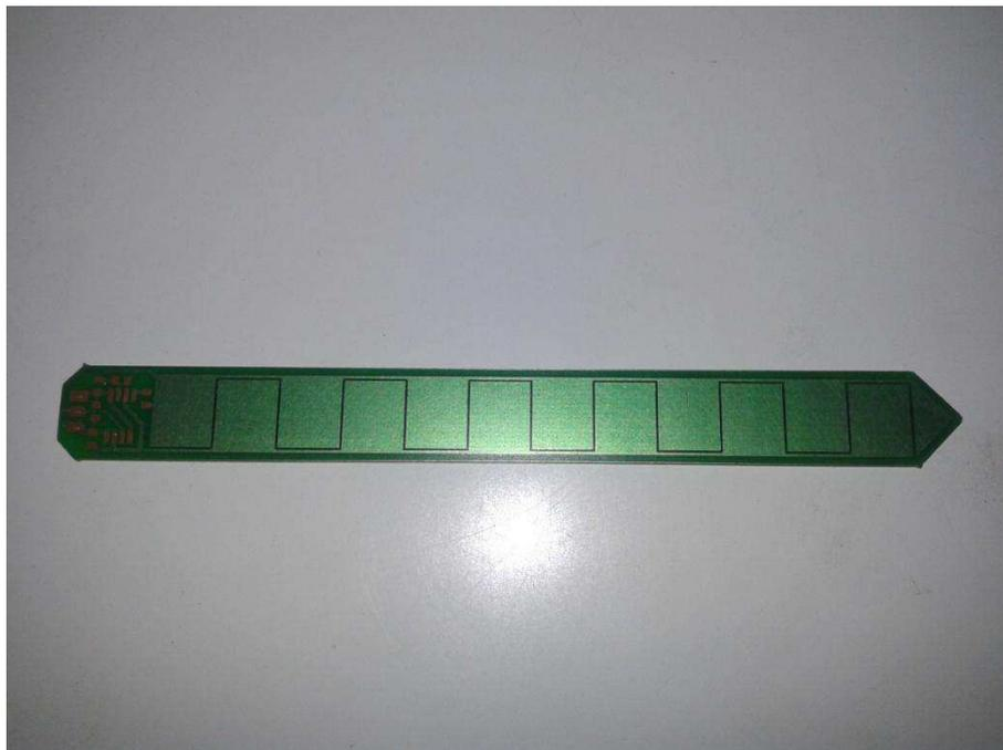
Figura 22: Sensor capacitivo interdigitado de uma face. O sensor de dupla face é praticamente idêntico, apresentando apenas uma trilha adicional simetricamente oposta ao plano longitudinal.
