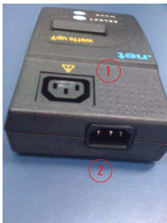
Figura 5.2. Saídas principais do Watts Up?. NET para conexão entre a fonte de alimentação e a carga.
