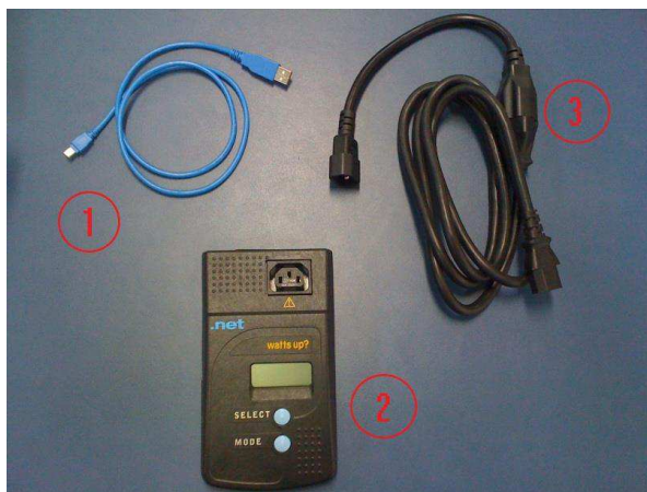
Figura 5.1. Composição do instrumento Watts Up?. NET , do fabricante Watts Up Meters .
