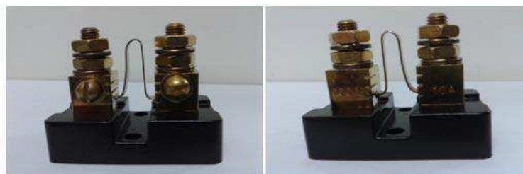
Figura 4.1 Fotografia do resistor shunt utilizado no aparato experimental em estudo.
