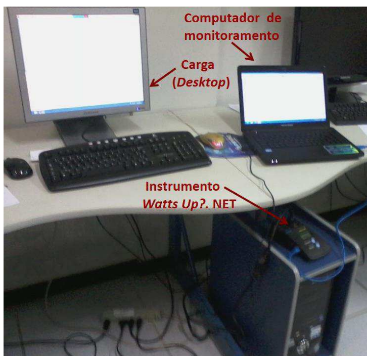
Figura 5.3. Sistema de medição completo usado na medição de potência para desktops .
