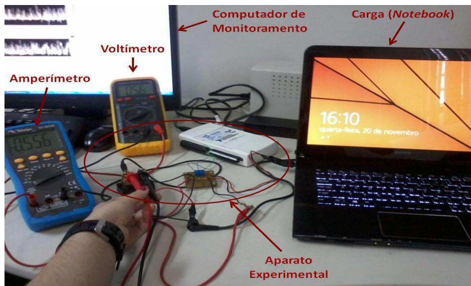
Figura 4.5. Inserção de dois multímetros no sistema de medição utilizado para notebooks/netbooks , de forma a verificar a corrente medida.
