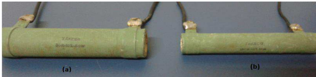
Figura 4.6. Fotografia dos resistores de potência: a) 30 \Omega 50 W ; b) 150 \Omega 30 W, utilizados para simular as cargas em estudo.
