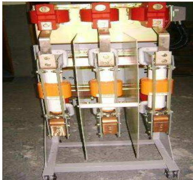
Figura 20: Imagem de um disjuntor a vácuo.
