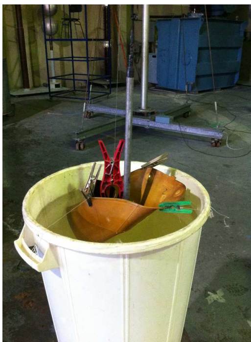
Figura 4.14 – Ensaio em manga isolante
