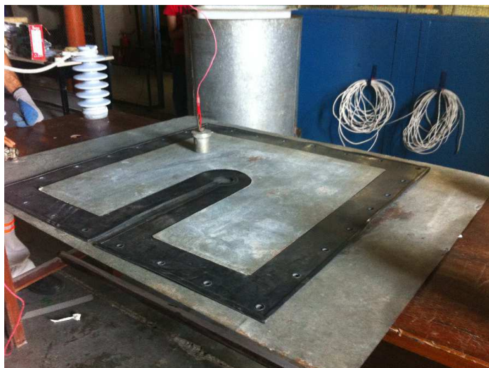
Figura 4.12 – Ensaio de lençol isolante.
