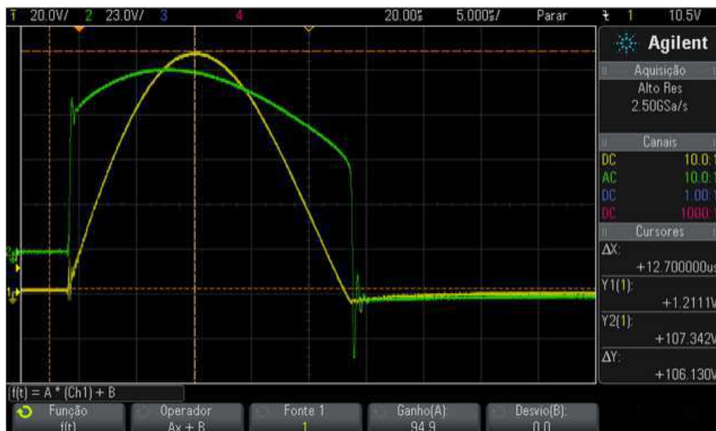
Figura 4.5 – Formas de onda de tensão e corrente.
