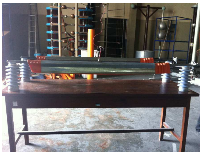
Figura 4.9 – Ensaio cobertura rígida.
