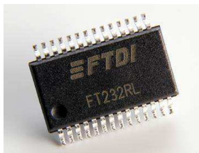
Figura 4.18. Chip conversor USB/RS-232.
