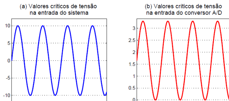
Figura 4.3. Valores críticos de tensão de entrada: a) no sistema b) no conversor A/D.
