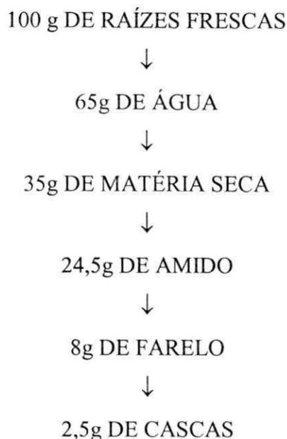
**Figura 2.4.** Balanço material teórico, para obtenção de amido em casas-de-farinha OLIVEIRA (1985)
