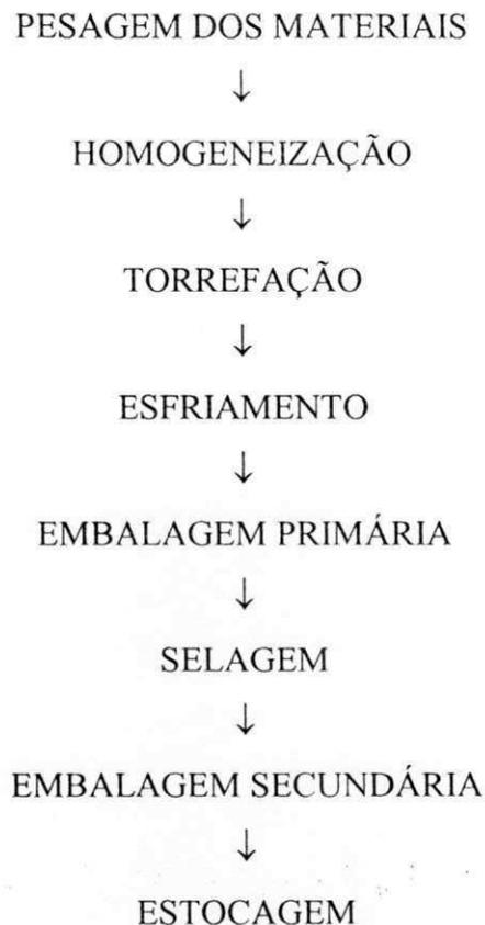
**Figura 3.1.** Fluxograma de processamento das farinhas de mandioca temperadas
