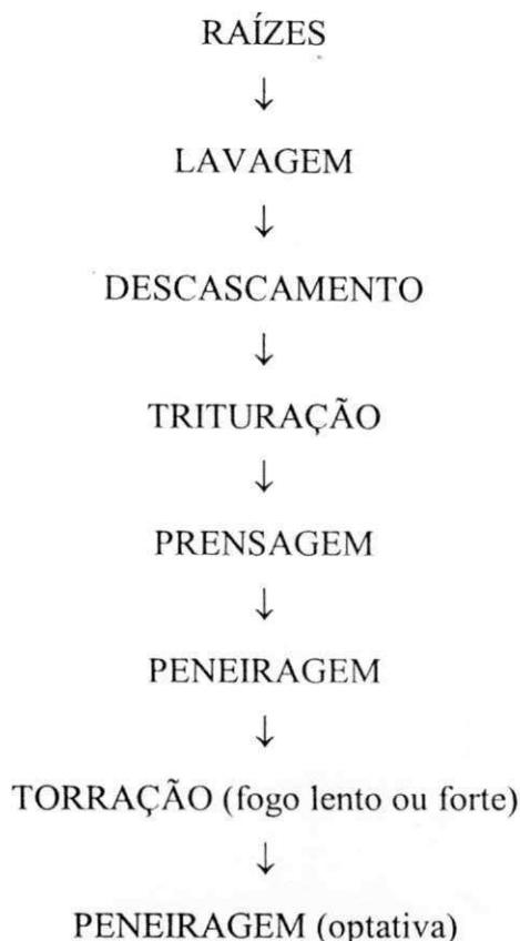
**Figura 2.2** Fluxograma para o processo de fabricação de farinha seca VILELA & JUSTE JÚNIOR (1987)
