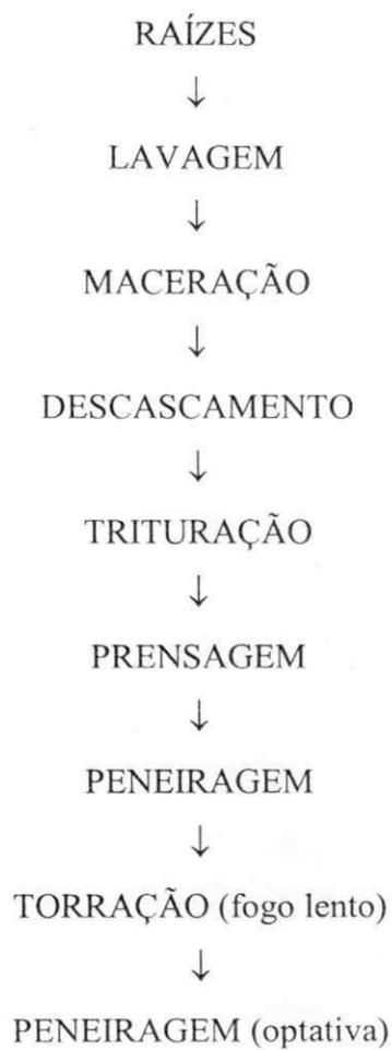
**Figura 2.1.** Fluxograma de fabricação de farinha d'água VILELA & JUSTE JÚNIOR (1987)
