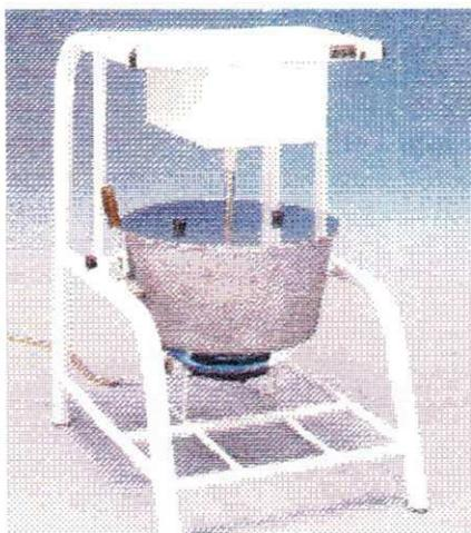
**Figura 3.2.** Tacho misturador elétrico, com aquecimento a gás
