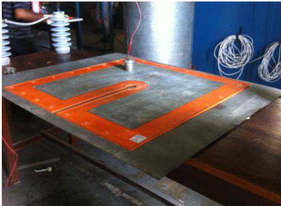
Figura 6: Ensaio de lençóis isolantes.
