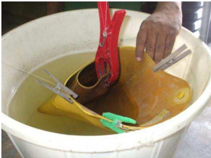
Figura 3: Ensaio de mangas isolantes.
