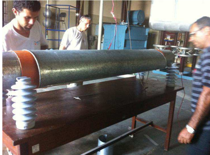
Figura 5: Ensaio da Cobertura Protetora Circular.
