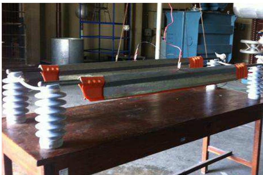
Figura 4: Ensaio de coberturas isolantes.
