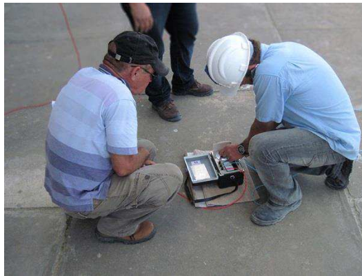
Figura 41 – Fotografia da equipe da Viridis Engenharia realizando as medições com o Terrômetro.
