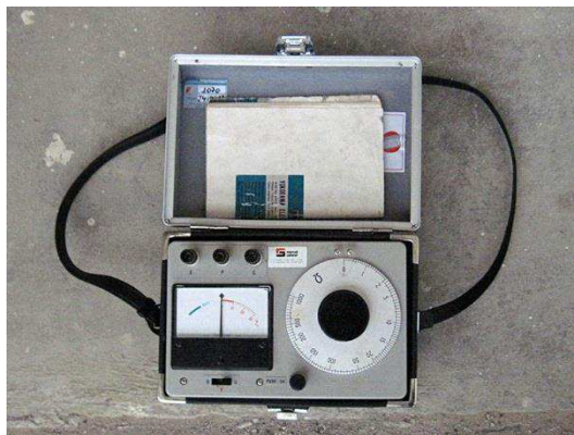
Figura 39 – Fotografia do Terrômetro utilizado nas medições da resistência de aterramento.
