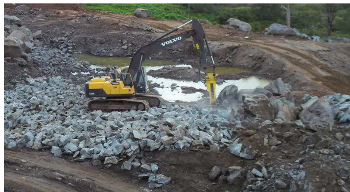
Figura 3 Rompedor hidráulico utilizado para redimensionamento de blocos com granulometria inapropriada para o britador.
