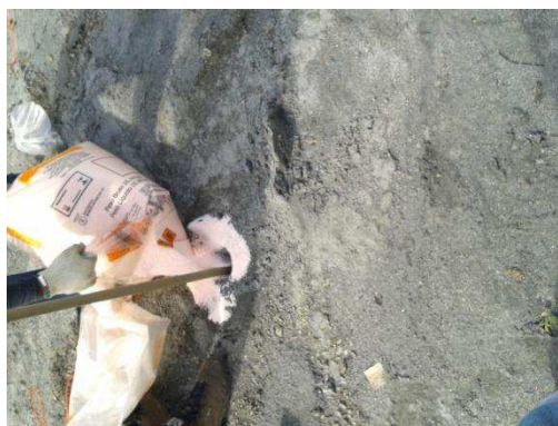
Figura 26 ANFO como carga de coluna.
