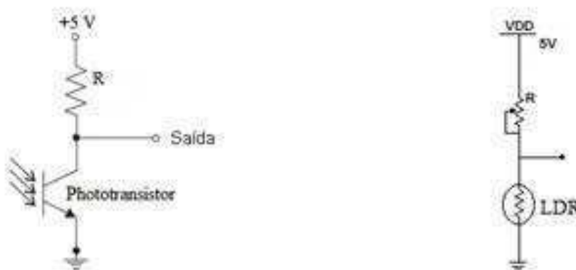
Figura 10: Circuitos drivers para o foto-transistor e o LDR.
