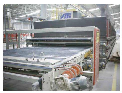
Figura 8 – Secador horizontal.
