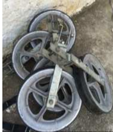
Figura 4.9: Roldanas utilizadas no lançamento de cabos.
