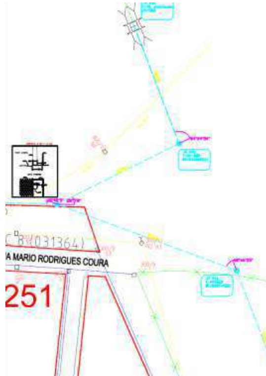
Figura 3.2: Detalhe da derivação da linha que liga a SE Campina Grande II à SE Esperança.
