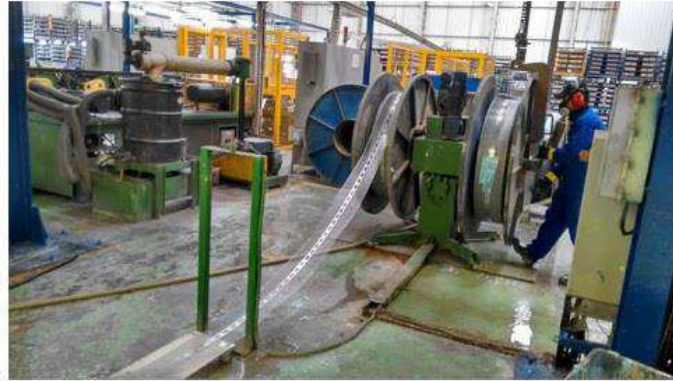
Figura 8. Empastamento de placas positivas.
