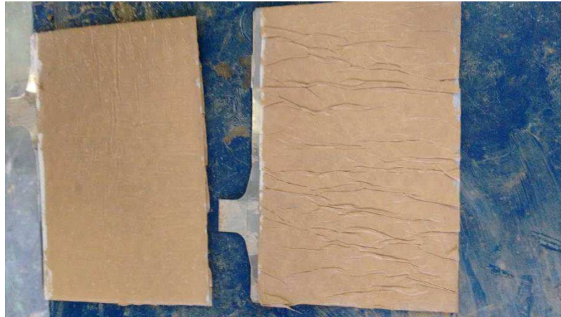
Figura 17. Comparativo entre placa normal e placa com enrugamento do past paper .
