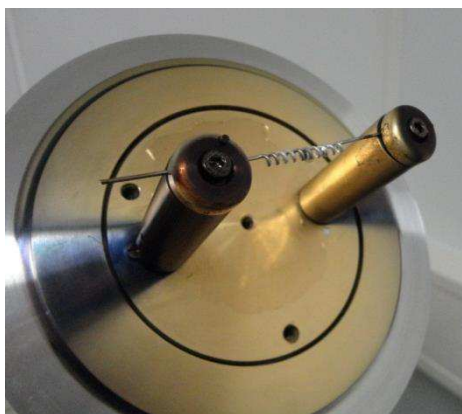
Figura 10: cadinho de tungstênio utilizado para fazer a deposição metálica
