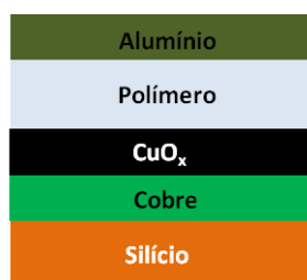
Figura 28: estrutura do empilhamento MIM das amostras oxidadas.
