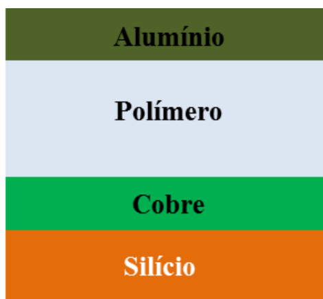
Figura 4: estrutura MIM do dispositivo CBRAM estudado utilizando silício como substrato.
