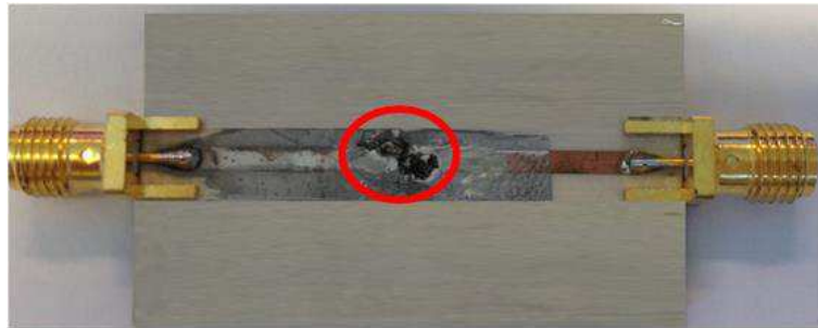
Figura 40: linha utilizada para a análise frequencial com pontos pretos associados à eliminação de fumaça após aplicação de tensões superiores a 10 V.
