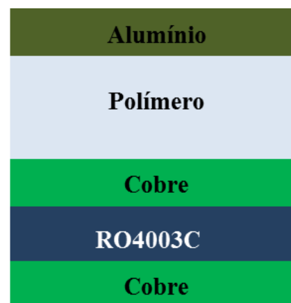
Figura 5: estrutura MIM do dispositivo CBRAM estudado utilizando RO4003C como substrato.
