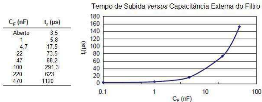
Figura 5.8. Curva característica de Tempo de Subida versus Capacitor de Filtro no sensor. Adaptado de: (ALLEGRO MICROSYSTEMS, 2013).
