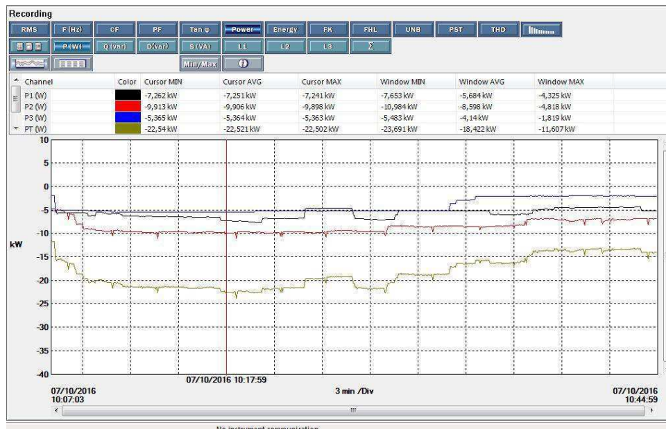
Figura 7 – Potência Ativa em cada fase do quadro de medição.
