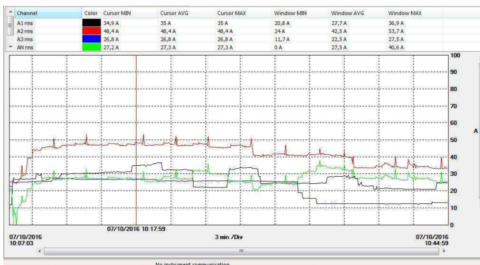
Figura 8 – Corrente em cada fase do quadro de medição.
