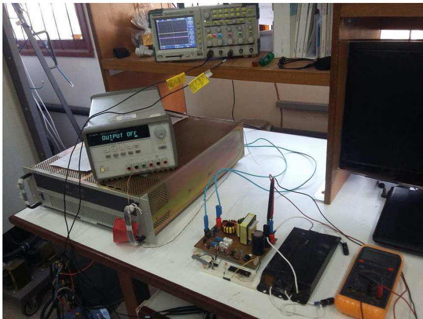
Figura 27 - Bancada para teste de funcionamento do conversor.
