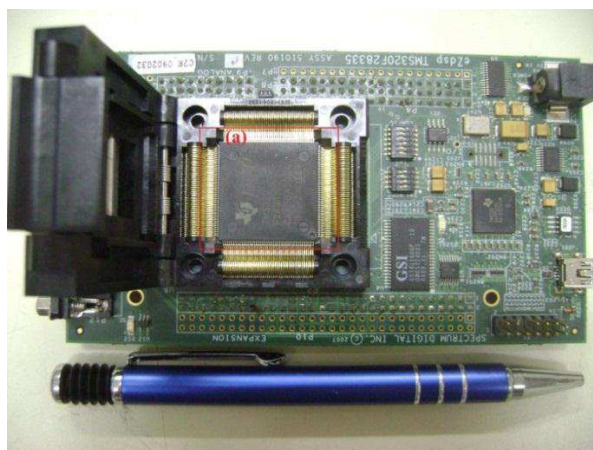
Fig. 5.2: Fotografia com detalhe do DSP TMS320F28335 utilizado no controle dos IGBTs.
