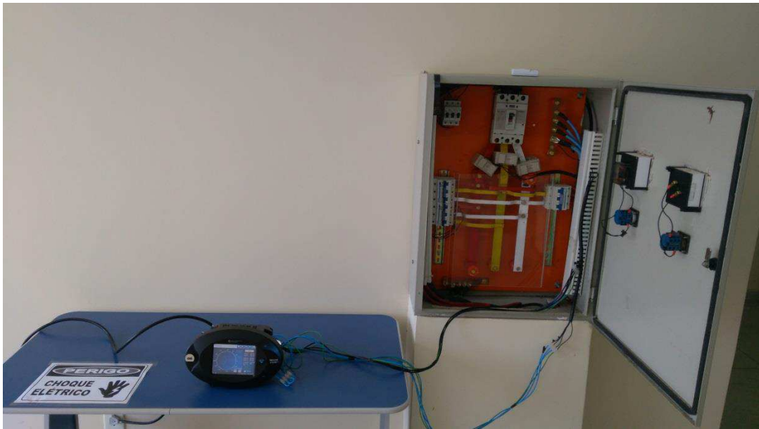
Figura 16 - Medição utilizando o qualímetro Nexus 1500+.
