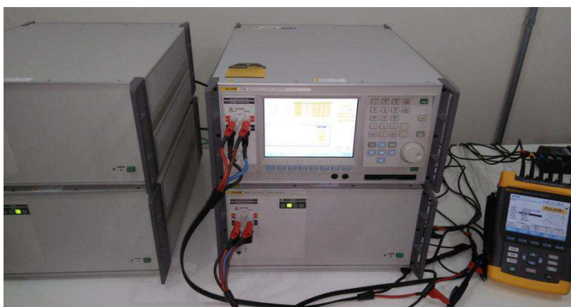
Figura 16: Setup de teste para o qualímetro.
