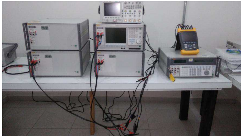
Figura 17: Configuração usada para gerar a tensão trifásica.
