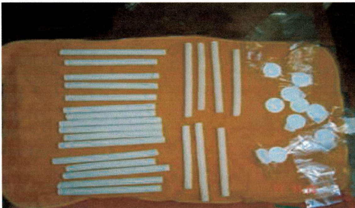
Figura 6.1 – Membranas tubulares de alumina, obtidas por extrusão, e membranas de alumina em forma de discos, obtidas por prensagem.
