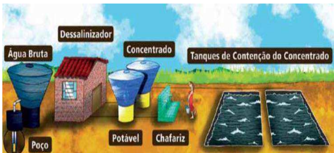
Figura 1: Ilustração do sistema simples do Programa Água Doce.
