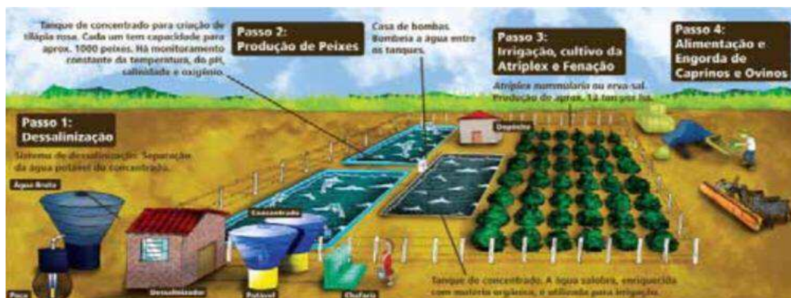
Figura 2: Ilustração do sistema completo do Programa Água Doce.
