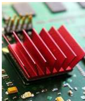
Figura 9 – Exemplo de um dissipador para ASIC.
