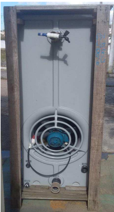
Figura 12: Torre de resfriamento
