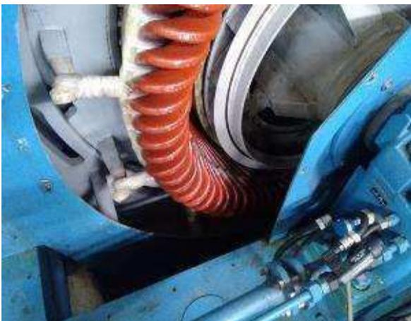
Figura 31: Estator sem vedação de ar
