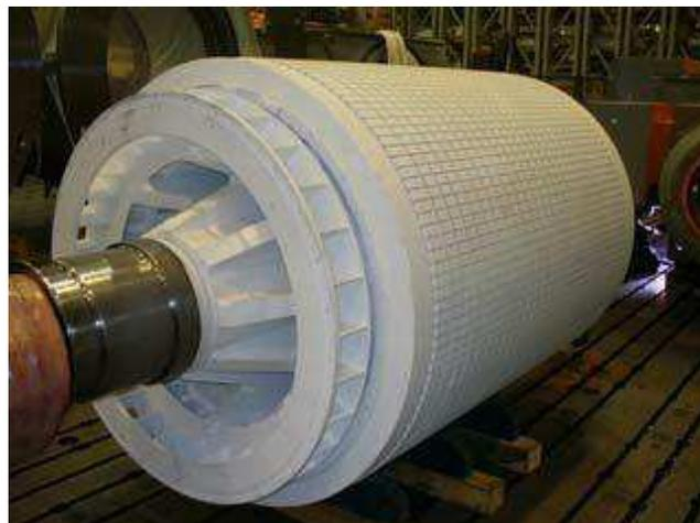
Figura 10: Rotor gaiola de esquilo com canais radiais de ventilação
