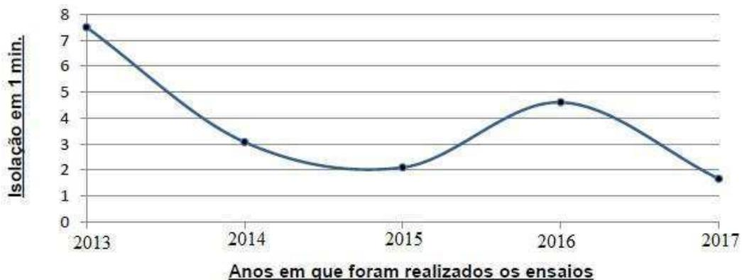
Figura 40: Curva tendência isolação do motor
