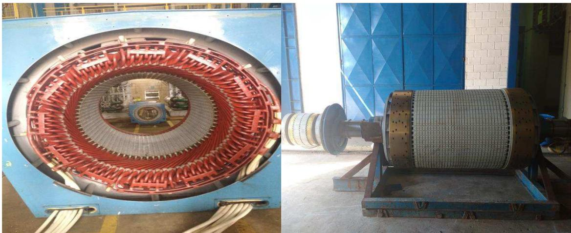
Figura 4: Estator e rotor de um gerador síncrono 25 MW
