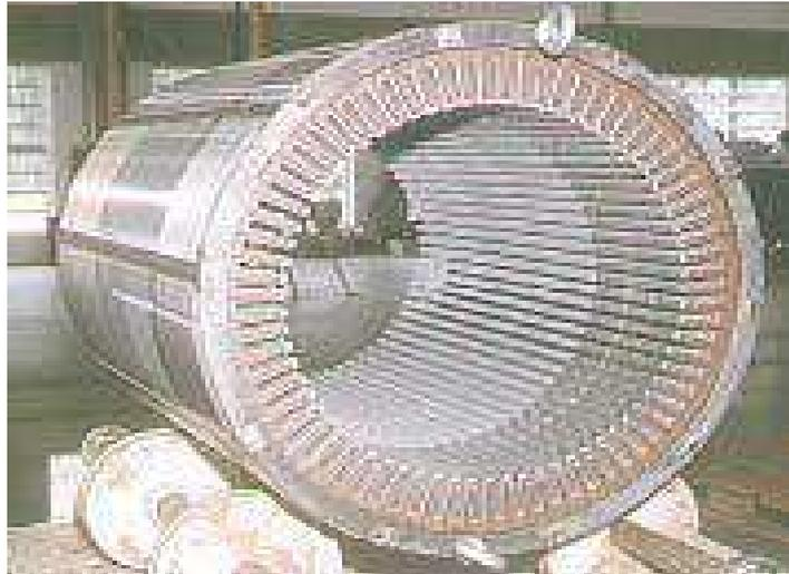
Figura 9: Pacote de capas do estator
