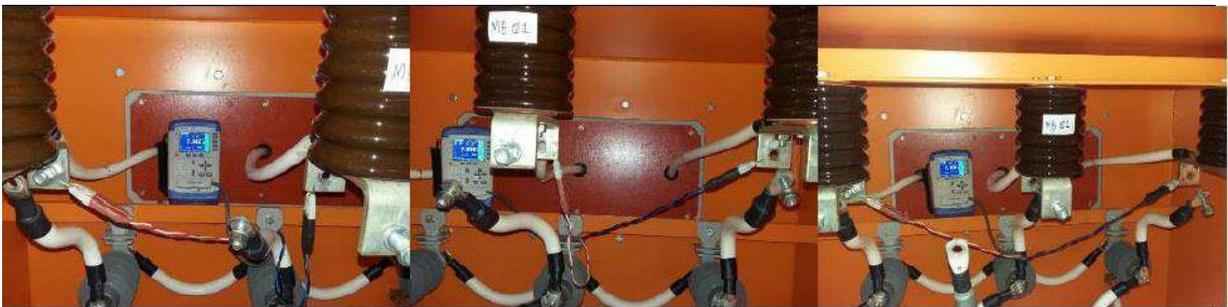
Figura 41: Medição nas fases U-V, V-W e W-U do estator
