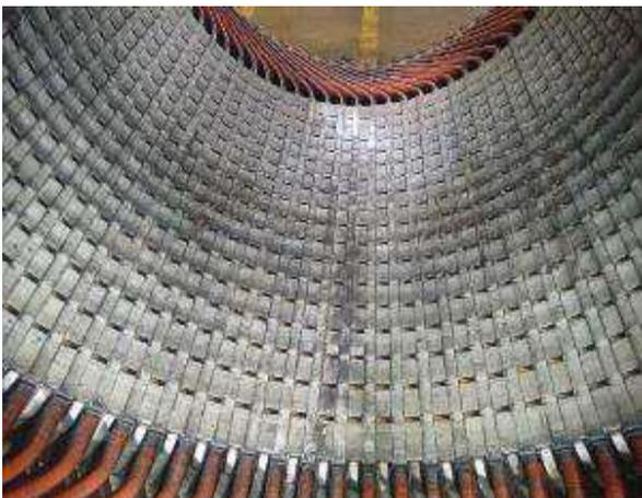
Figura 21: Bobinado e estator sujos
