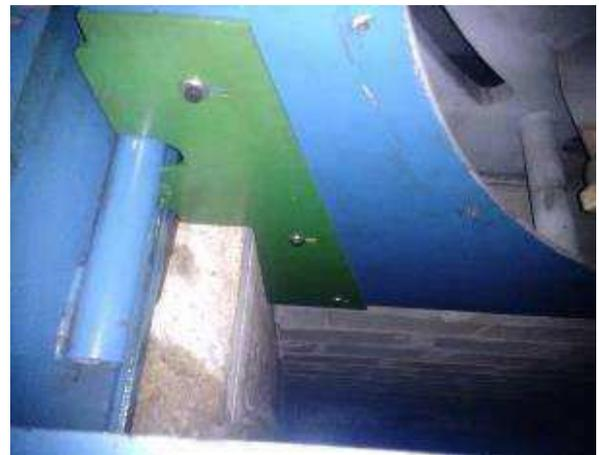
Figura 32: Estator com vedação de ar
