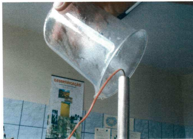
Figura 4.56 – Coleta do vapor de água na saída da chaminé
