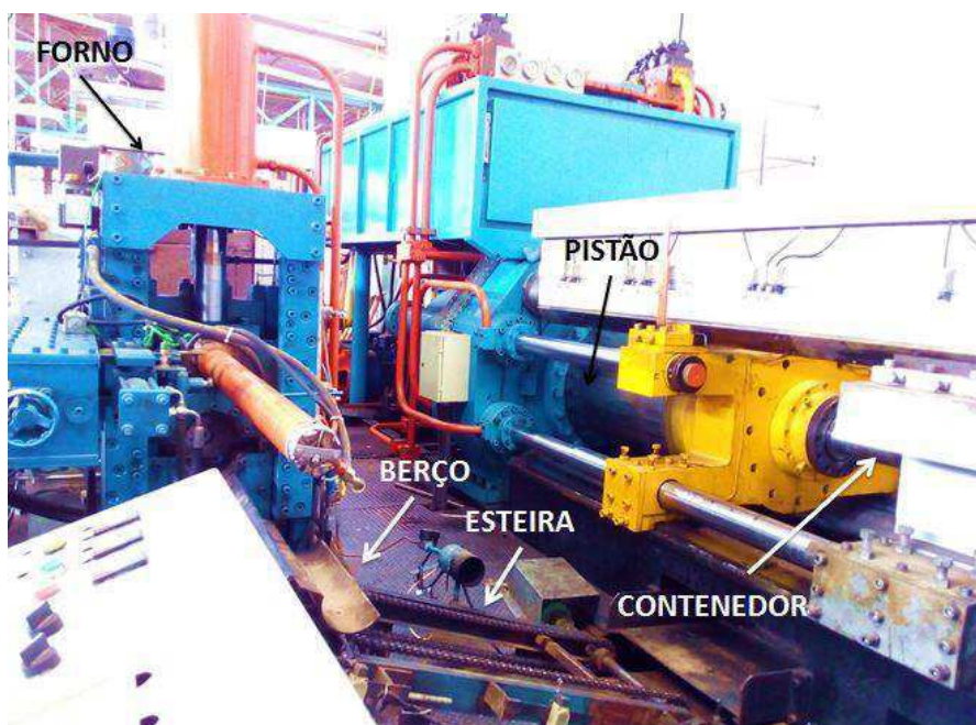
Figura 4 - Processo inicial da extrusão.
