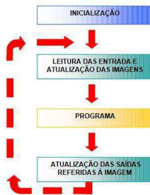
Figura 7 - Ciclo de processamento dos CLPs (Laboratório de Engenharia Elétrica - Universidade do Estado do Rio de Janeiro, 2016).
