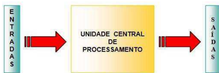
Figura 6 - Estrutura básica de um CLP (Laboratório de Engenharia Elétrica - Universidade do Estado do Rio de Janeiro, 2016).
