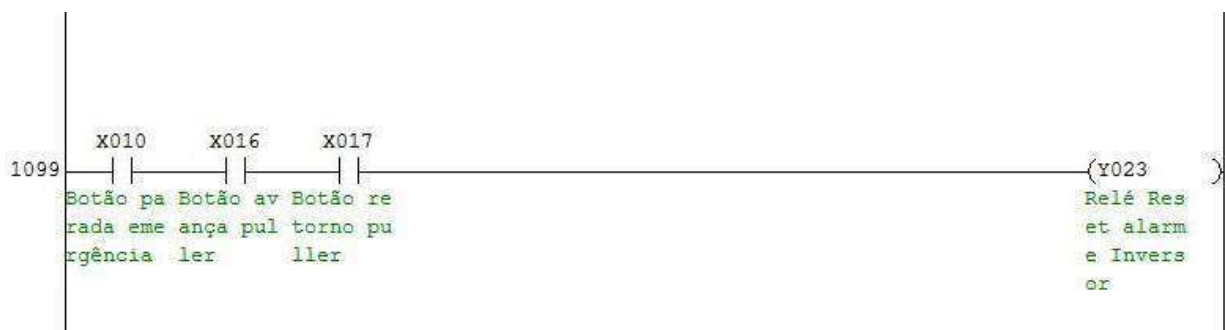
Figura 17 - Reset do inversor.
