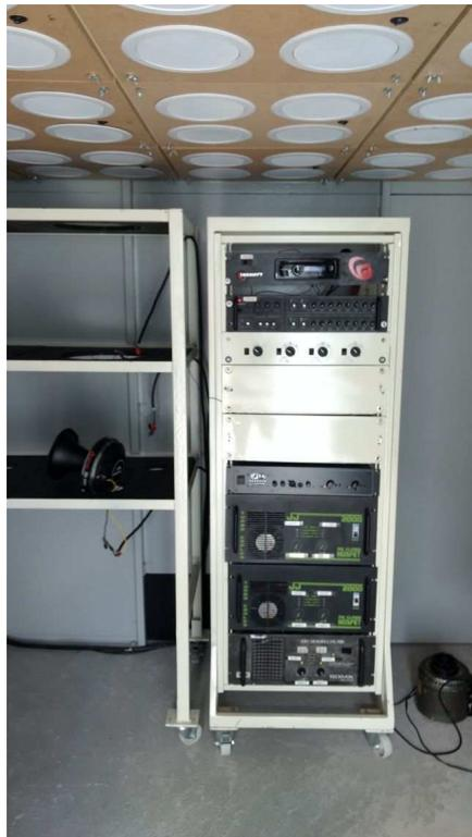
Figura 27 – Visão dos amplificadores utilizados para testar os alto-falantes no teste de vida do setor de engenharia.
