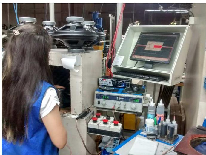
Figura 29 – Teste de alto-falante utilizando o sistema CLIO.
