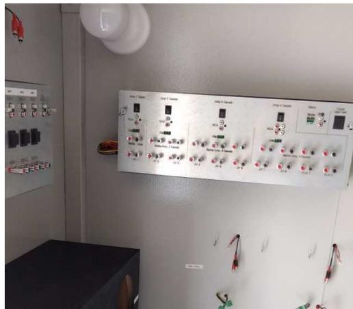
Figura 24 – Painel utilizado nos testes de amplificadores automotivos.
