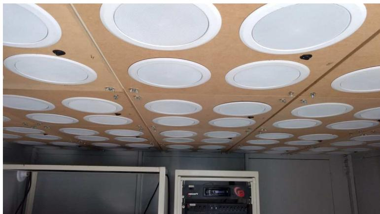
Figura 26 – Visão das arandelas instaladas no teto do teste de vida para realizar testes com os amplificadores residenciais e com os transformadores.
