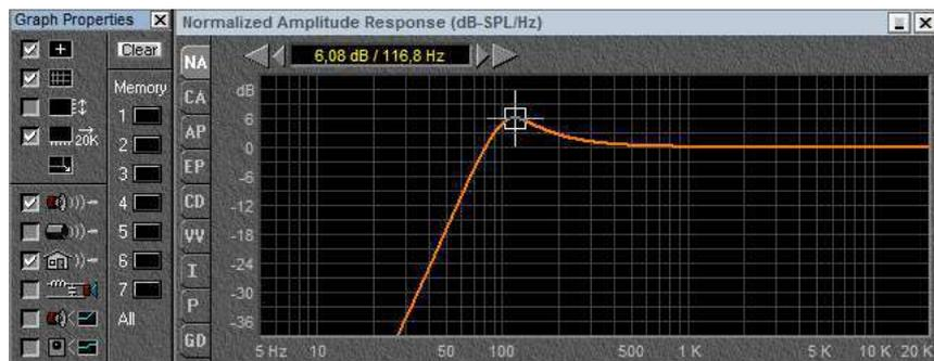
Figura 22 – Simulação do projeto da caixa do alto-falante 12 SW 3K.
