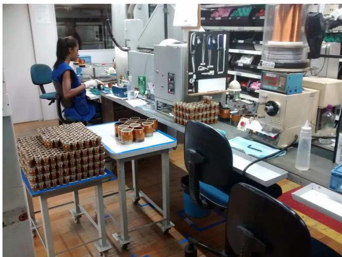
Figura 31 – Parte do processo de fabricação de bobinas para alto-falantes.
