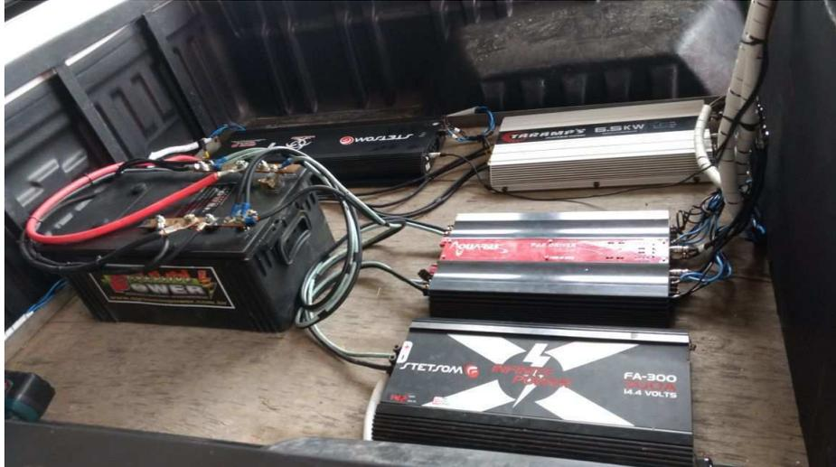
Figura 20 – Amplificadores e fontes utilizadas na montagem do sistema de som automotivo 4 vias.
