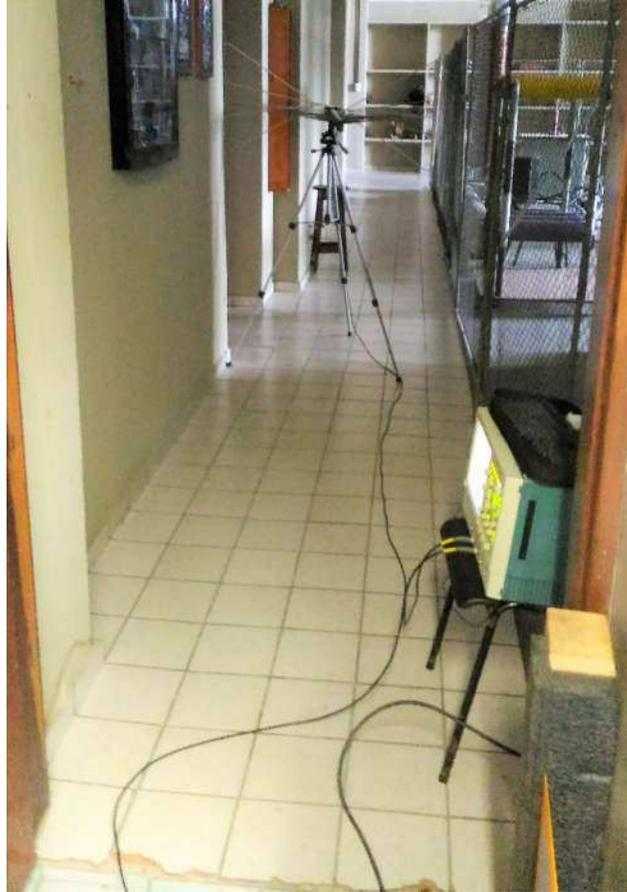
Figura 18 - Arranjo Experimental para Medição do Sinal Eletromagnético com a Antena Tipo *Patch* Perpendicular à Antena Direcional.
