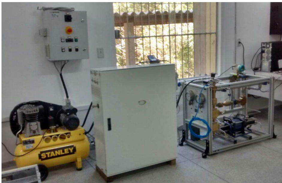
Figura 2.2 - Sistema de produção de hidrogênio eletrolítico LABFREN.
