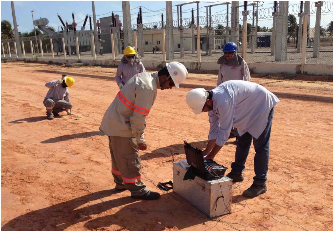
Figura 17: Análise de Resistência e Resistividade do Solo
