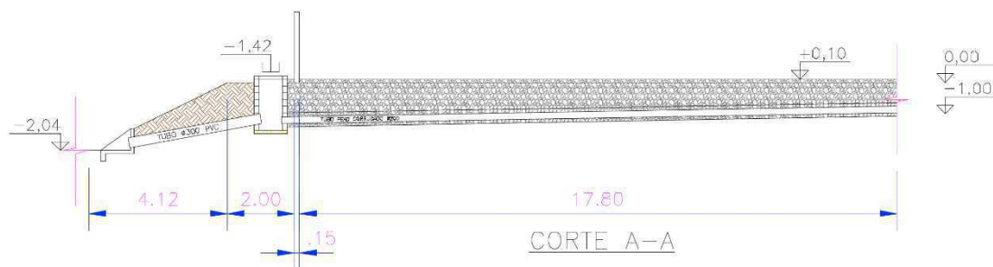
Figura 19: Vista do corte no Projeto da Drenagem
