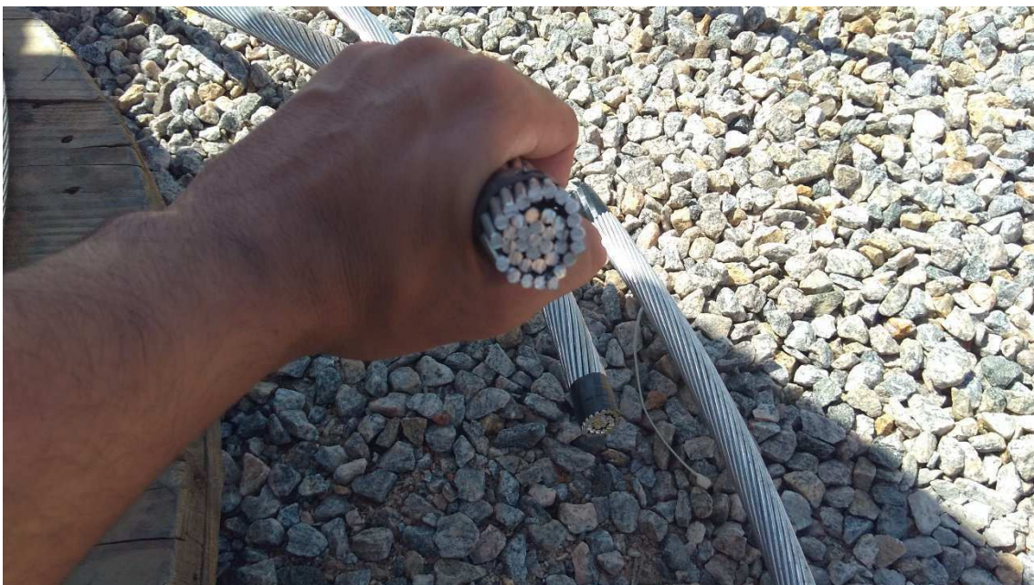
Figura 28: Corte Transversal em cabo Flint
