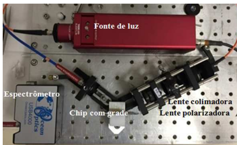
Figura 5.6 Montagem construída para experimentos no modo AIM com o dispositivo com grade metálica de ouro. Semelhante ao setup utilizado no estudo WIM, com exceção de um filtro óptico que garante que apenas o feixe com comprimento de luz de 820 nm chegue até a superfície de grade.
