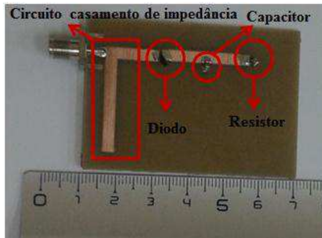
Figura 38: Circuito retificador sem filtro fabricado.
