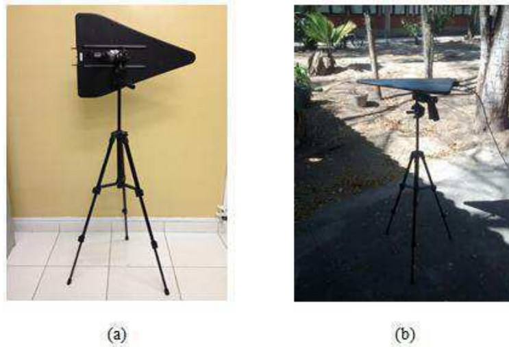
Figura 26: Antena usada para medições; (a) posicionada verticalmente ; (b) posicionada horizontalmente.
