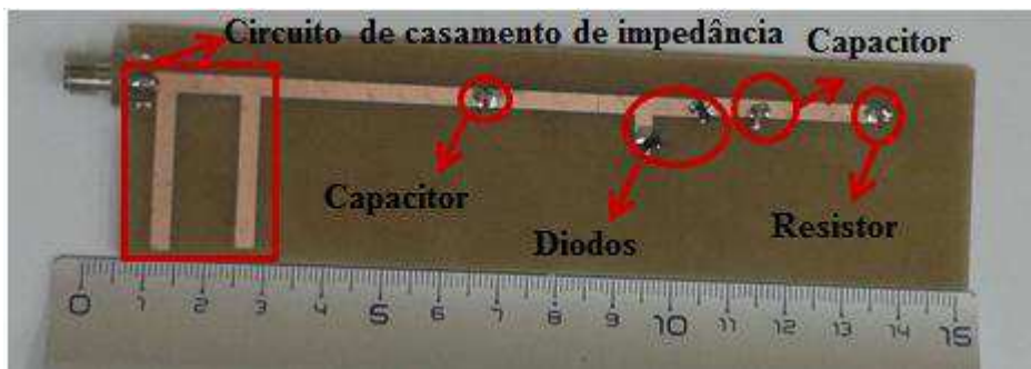
Figura 49: Circuito dobrador de tensão fabricado.
