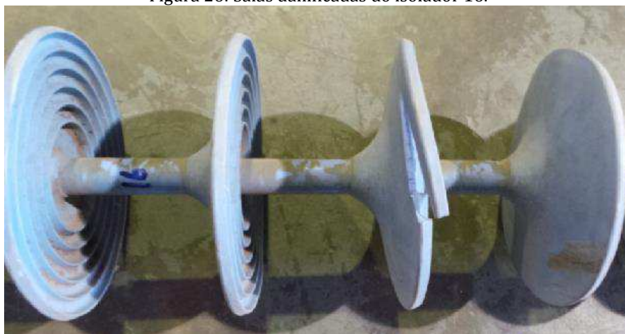
Figura 26: Saias danificadas do isolador 16.
