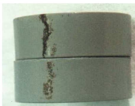
Figura 4.2 – Colar isolante de varistores degradados devido à ação de descargas parciais.
