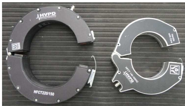
Figura 5.7 – Fotografia dos HFCT utilizados.
