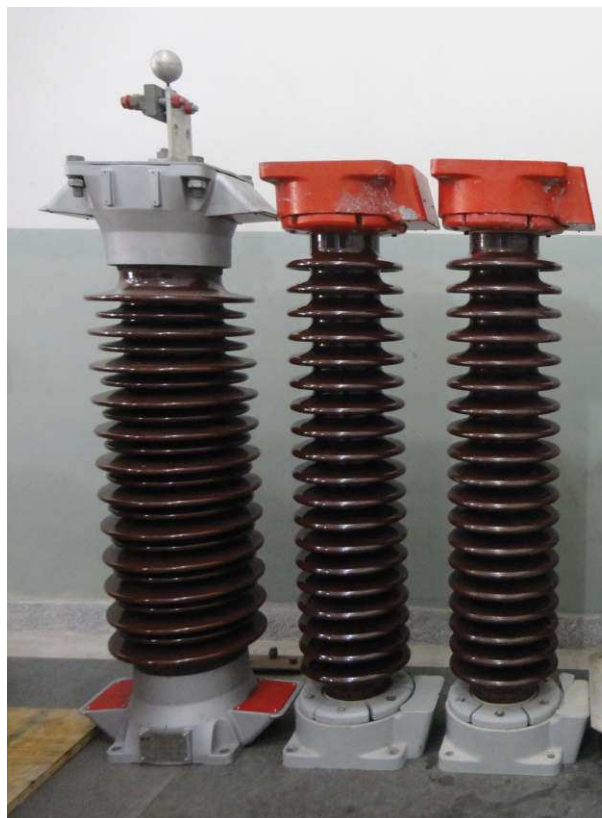
Figura 5.2 – Fotografia dos para-raios utilizados. Da esquerda para a direita: PR_A , PR_B e PR_C .
