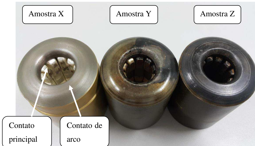
Figura 4.2: Amostras de contato fixo do disjuntor SIEMENS.
