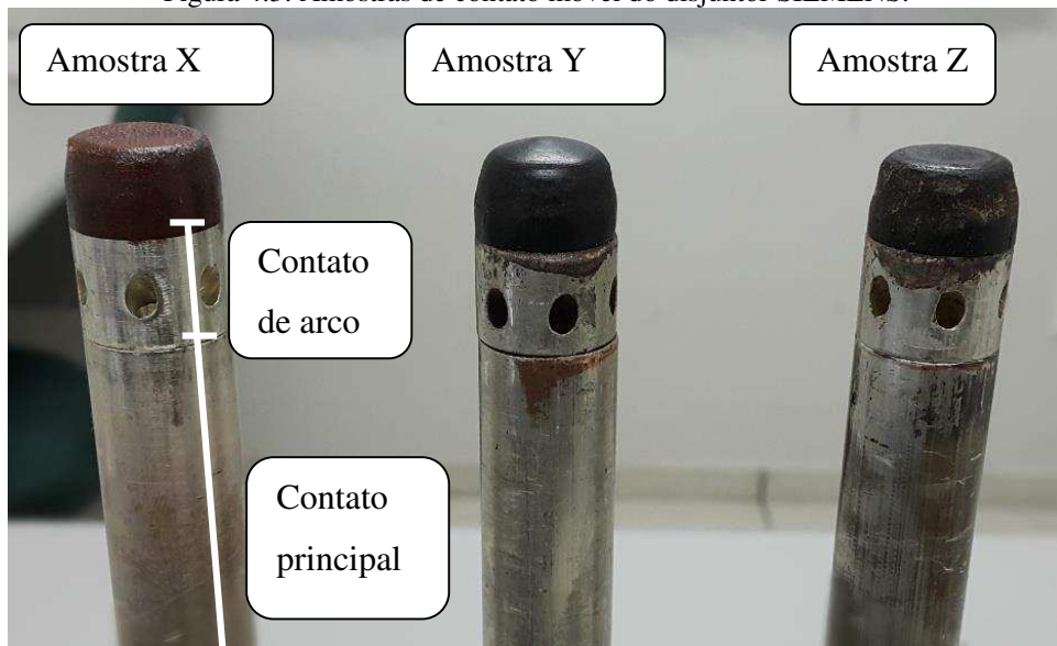
Figura 4.3: Amostras de contato móvel do disjuntor SIEMENS.
