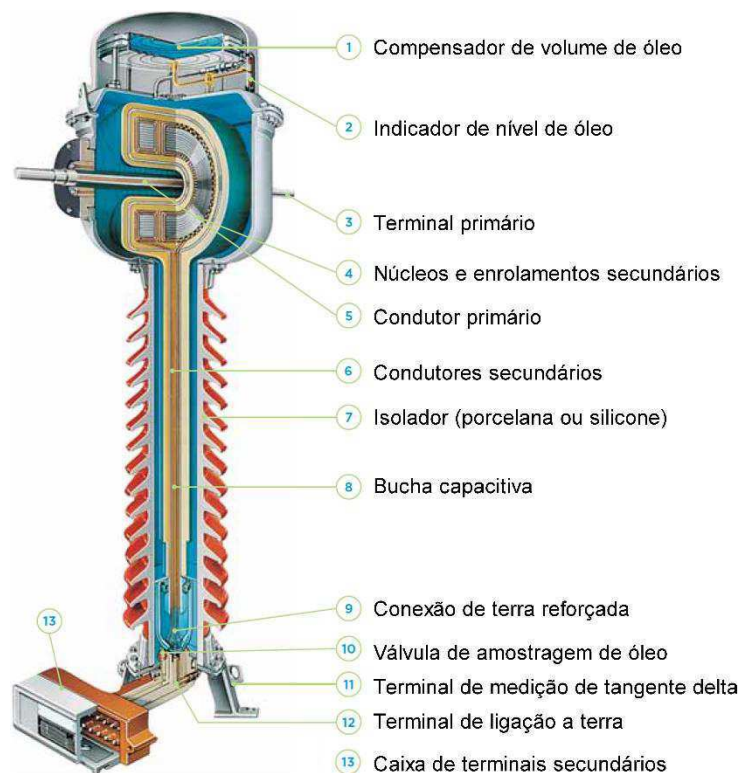
Figura 1 - Detalhes de um TC de 245 kV.
