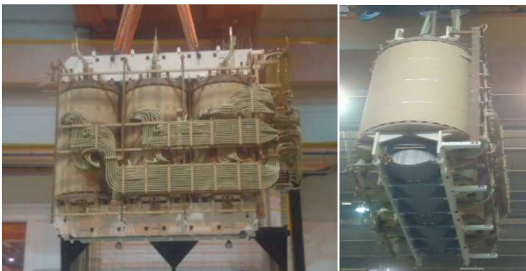
Figura 2. 3– Vista frontal e vista inferior da Parte Ativa de Transformador trifásico – Fabricante D
