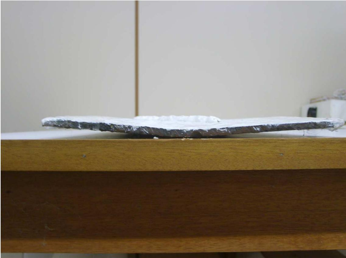
Figura 20. Curvatura da superfície usada nos testes.
