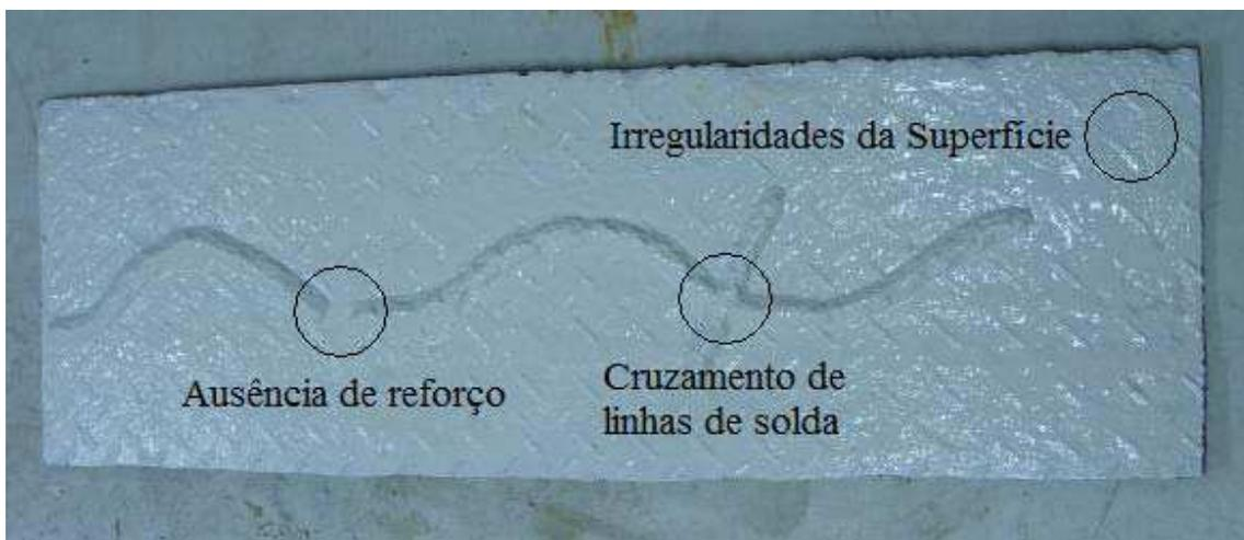
Figura 21. Dificuldades normalmente encontradas no ambiente de operação do robô.
