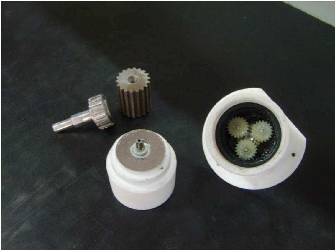
Figura 49. Peças confeccionadas para a fabricação do protótipo.
