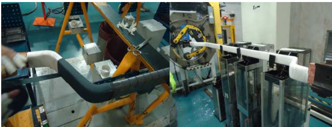
Figura 5.7: Fotografia do processo de enfitamento da barra do estator.
