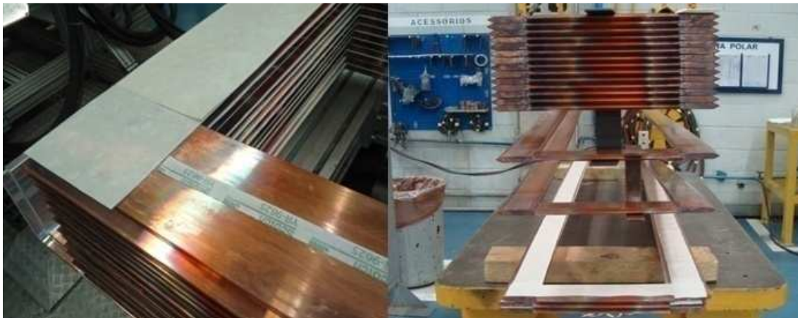
Figura 5.44: Espiras da bobina polar recebendo o isolamento Nomex.
