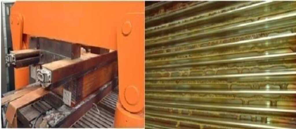
Figura 5.45: Compactação à quente das espiras da bobina polar.
