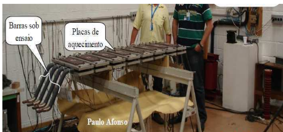
Figura 5.12: Amostras sob ensaio de envelhecimento.
