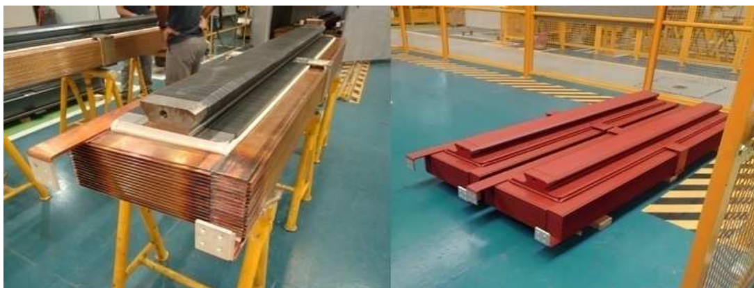
Figura 5.46: a) Montagem da bobina com o isolamento contra o núcleo. b) Pólos acabados.
