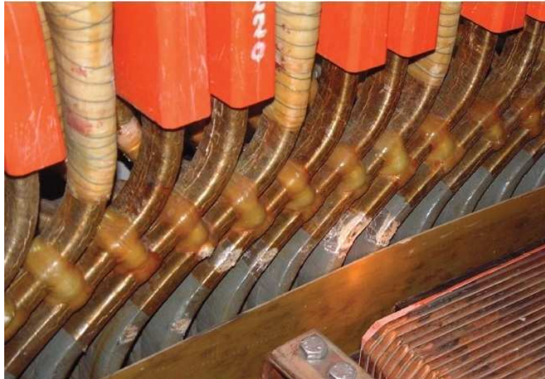
Figura 5.21: Extremidade das bobinas estatóricas, mostrando a pintura semicondutora (regiões em cinza) aplicada imediatamente após a saída do núcleo estatórico.
