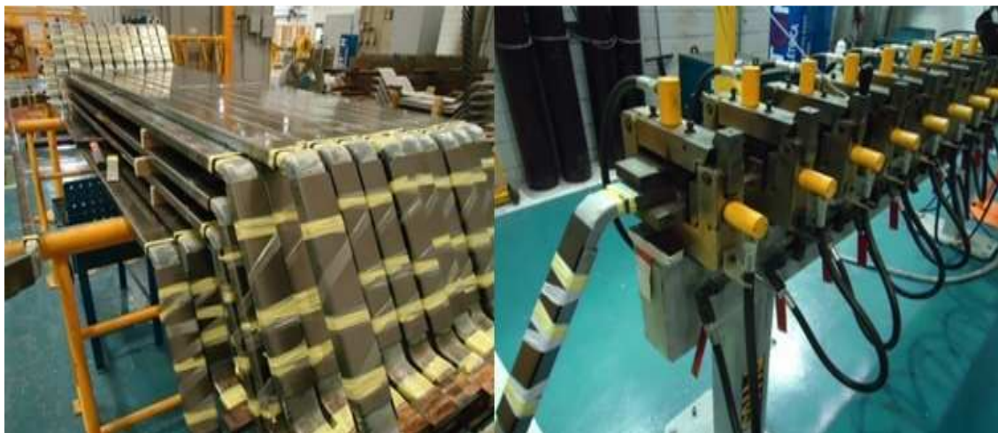
Figura 5.8: Fotografia do processo de travamento das barras no dispositivo.
