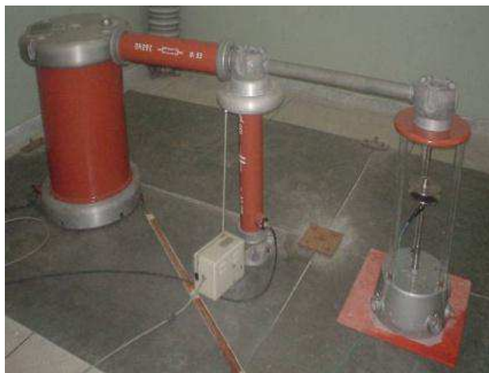
Fig. 4.10: Kit de alta tensão preparado para realização de ensaio de caracterização, na fotografia não aparecem o osciloscópio nem o resistor shunt .
