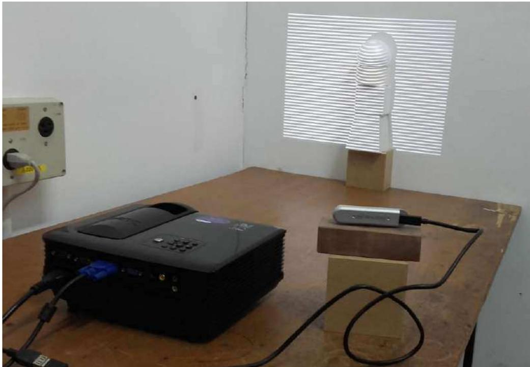
Figura 11 – Imagem do sistema físico de medição *Fringe*
