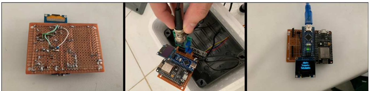
Figura 13: Montagem do sistema com placa de circuito impresso artesanal
