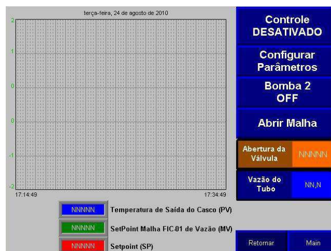
Figura 30 - Janela dos Gráficos Malha de Temperatura TIC-02 em Cascata com FIC-01
