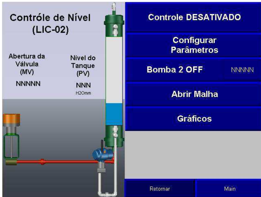
Figura 21 - Janela da Malha de Nível LIC-02
