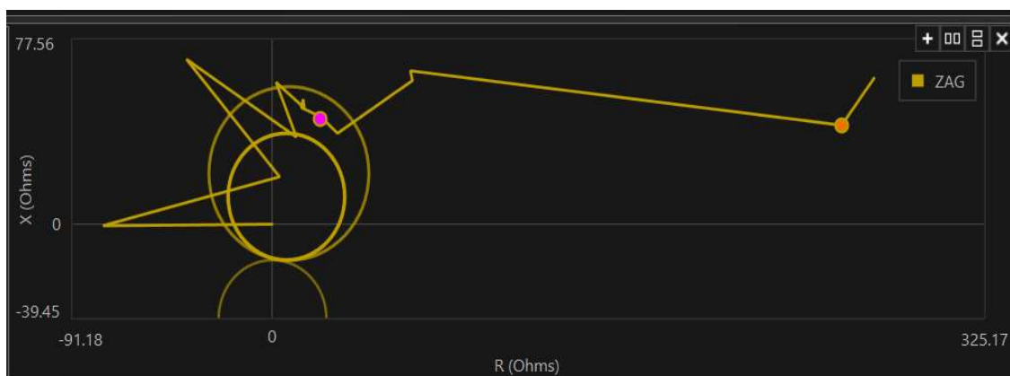
Figura 20: Diagrama R-X, falta trifásica.
