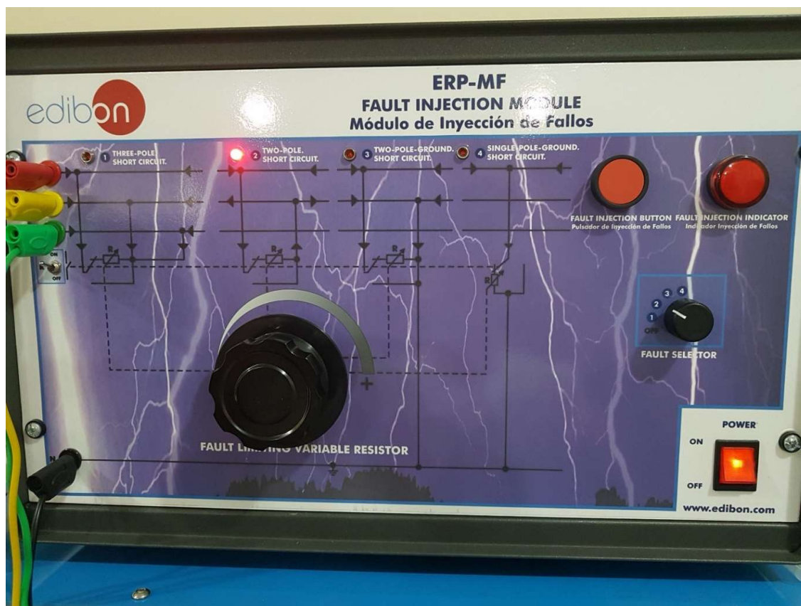
Figura 15: Módulo de injeção de faltas energizado e pronto para uso.
