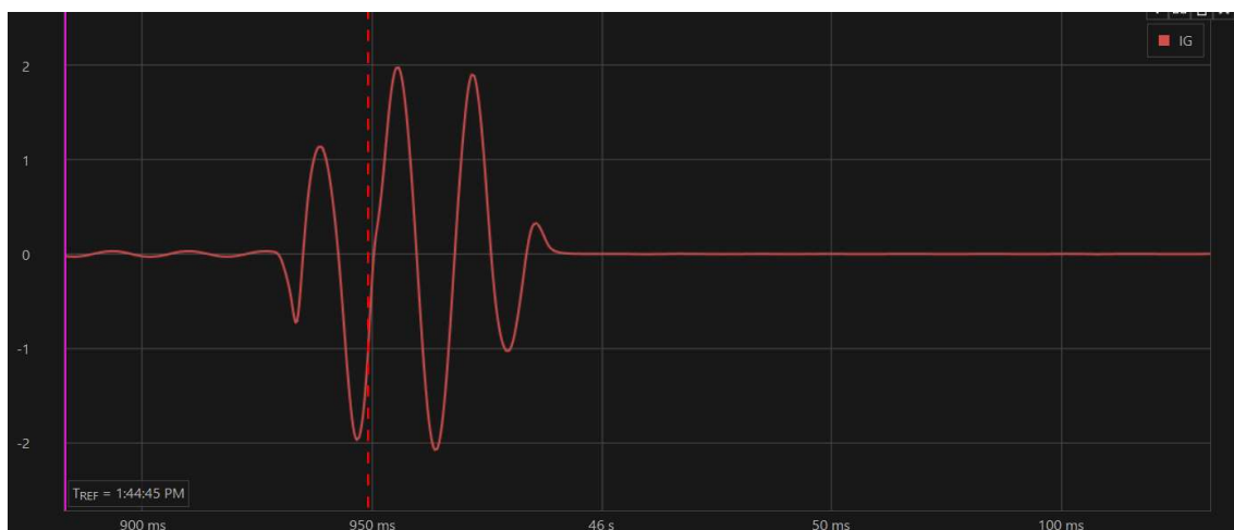
Figura 28: Corrente de terra IG, falta fase-fase-terra.
