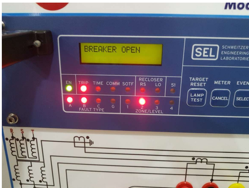
Figura 31: Detecção de falta fase-fase.
