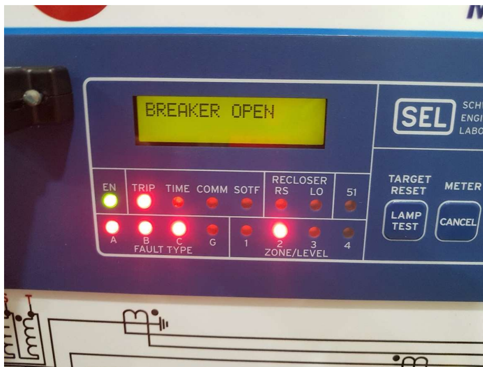
Figura 16: Detecção de falta trifásica.
