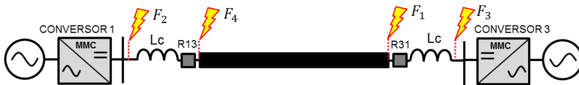
Figura 11 – Linha entre conversores 1 e 3 e posições dos casos de faltas referenciados nesse trabalho.
