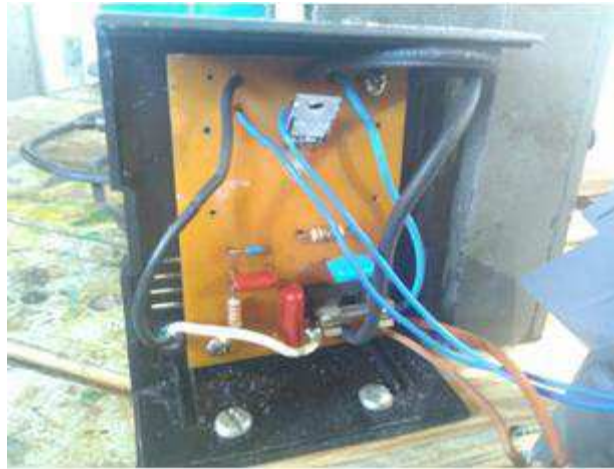
Figura 10 - Montagem do controle de velocidade: (a) Carcaça com circuito integrado; (b) Carcaça com comando de acionamento.
