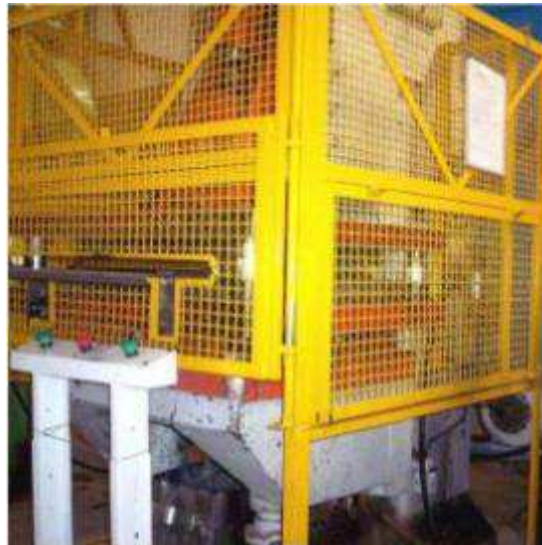
Figura 10: Exemplo de proteção de máquina – isolamento móvel e barreira fotoelétrica
